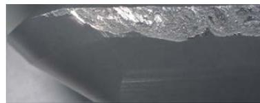
Ejemplo de agrietamiento térmico
